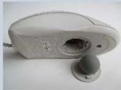
Aujourd’hui, les souris sont progressivement remplacées par des souris optiques. Le système à boule avait en effet tendance à ramasser la poussière, la crasse de la surface horizontale et à encrasser les rouleaux capteurs, ce qui exigeait un nettoyage interne régulier
